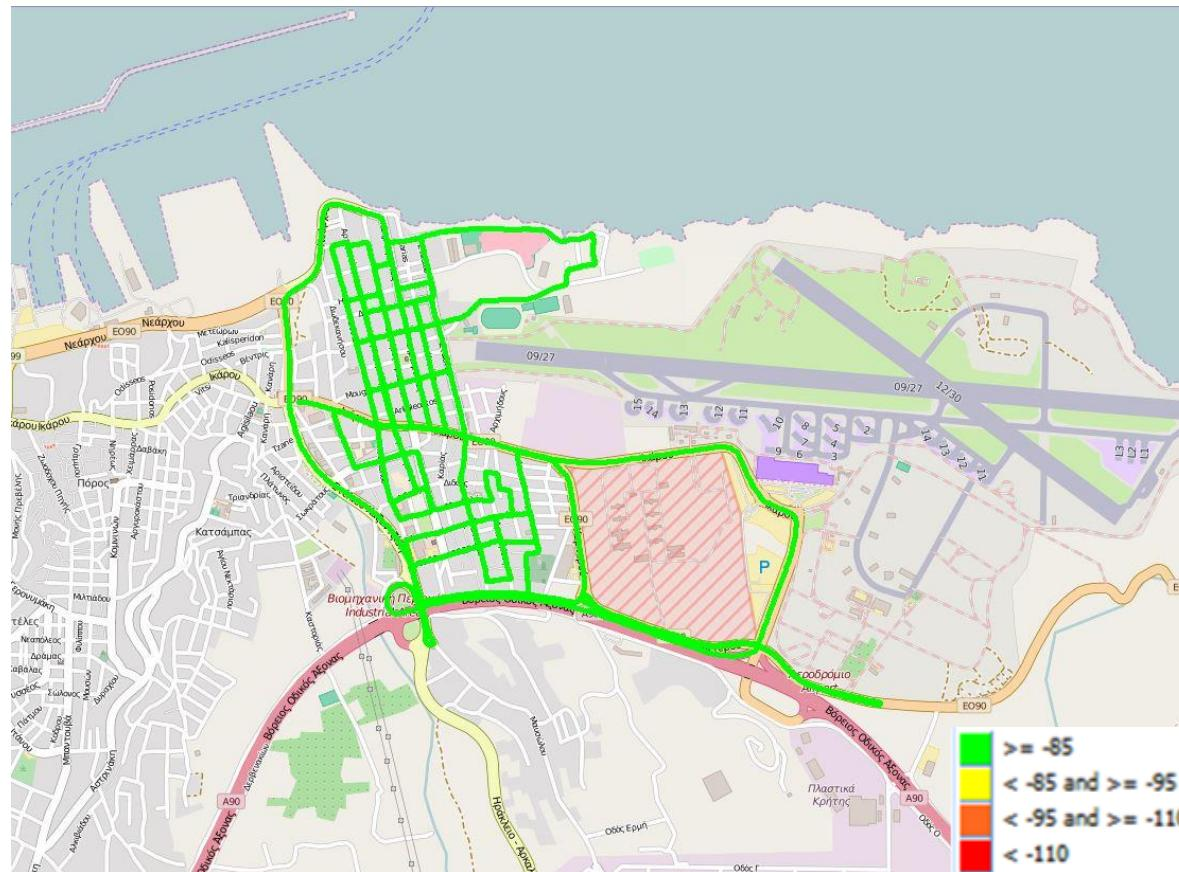
Εικόνα 13-1: Ραδιοκάλυψη WIND – GSM
