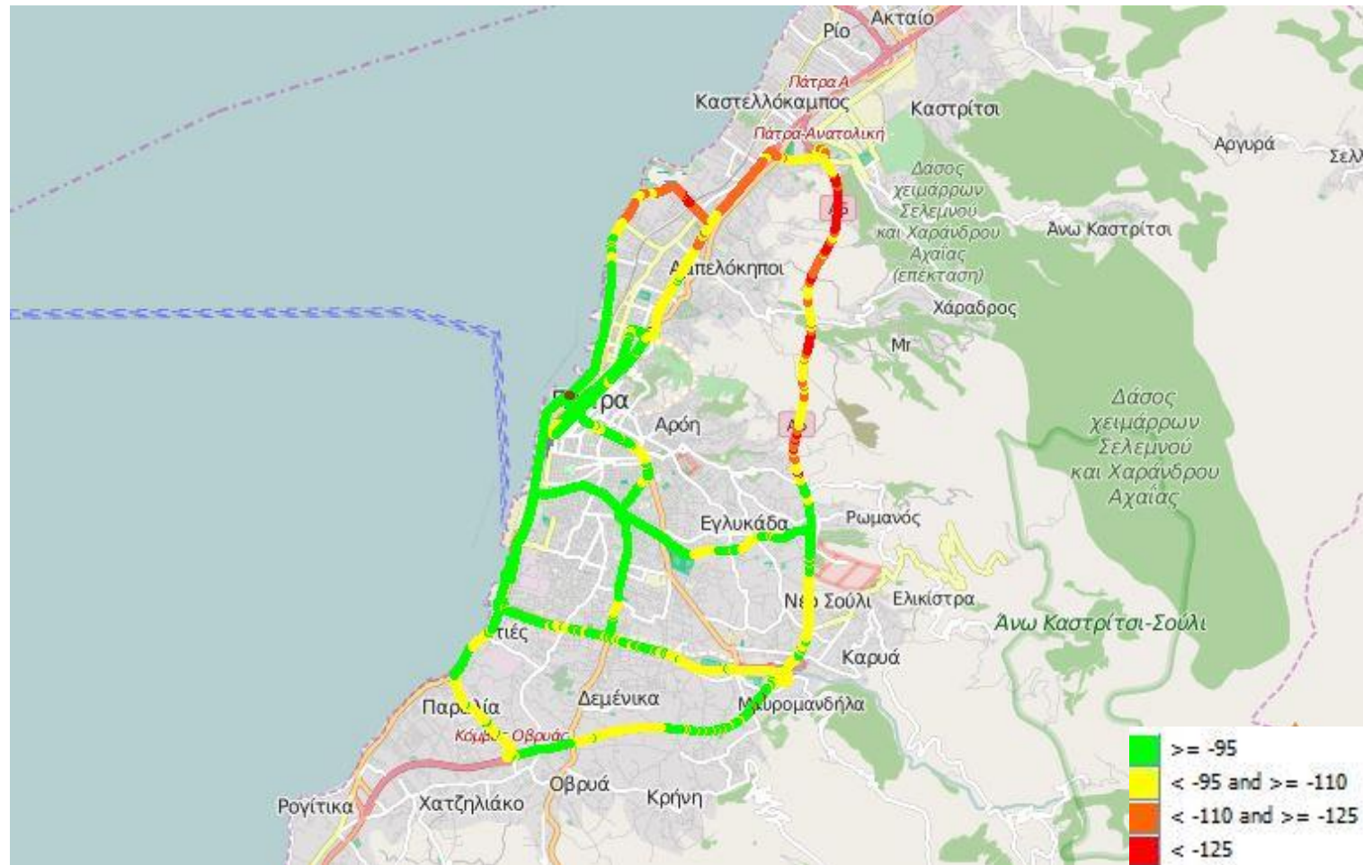
Εικόνα 13-3: Ραδιοκάλυψη Wind – LTE
