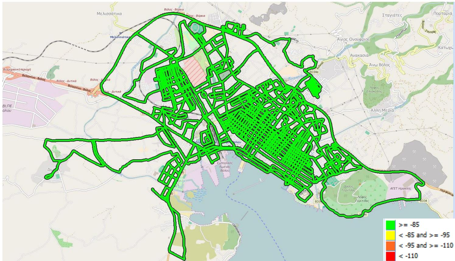
Εικόνα 13-1: Ραδιοκάλυψη WIND – GSM
