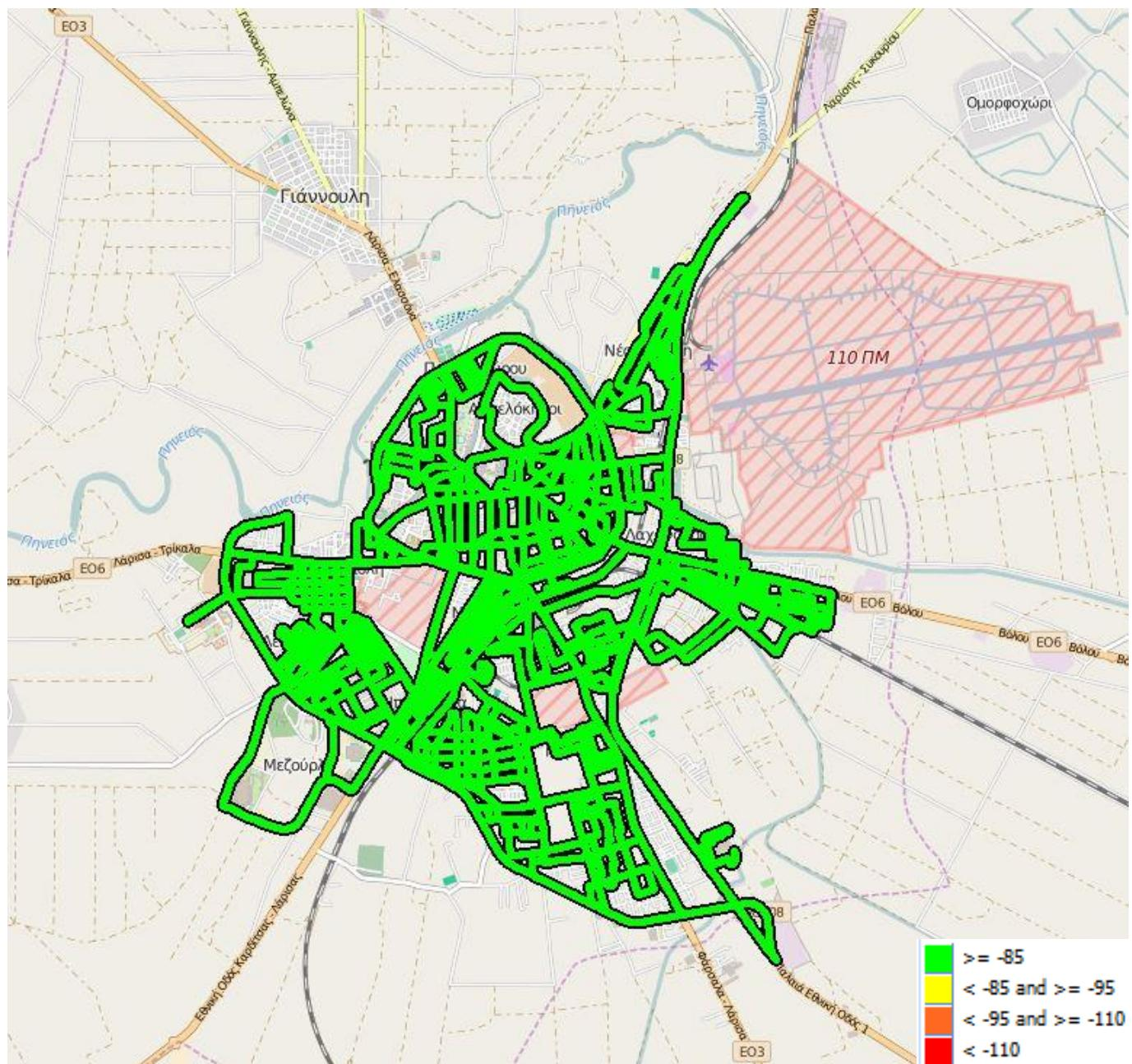
Εικόνα 13-1: Ραδιοκάλυψη WIND – GSM
