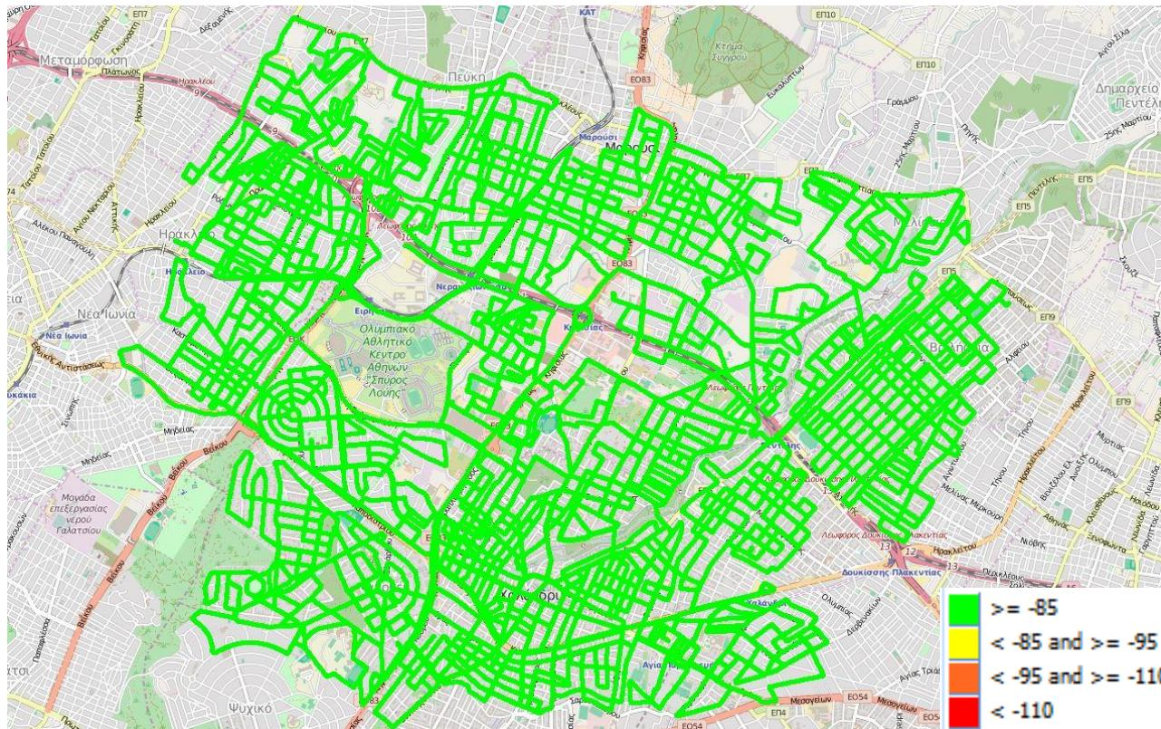
Εικόνα 13-1: Ραδιοκάλυψη WIND – GSM
