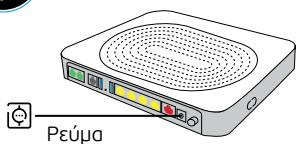
Σύνδεσε το καλώδιο τροφοδοσίας στο router και στην πρίζα ρεύματος. Πάτησε το κουμπί ① για να ανοίξει το router.
